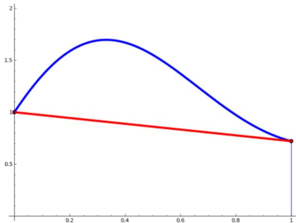
Aproximamos el área bajo la curva  $f$  mediante el área bajo la recta que interpola  $(a, f(a))$  y  $(b, f(b))$ .
