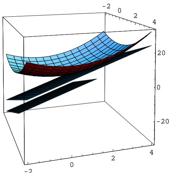
Figura 4.3: Plano tangente a  $f(x, y) = x^2 + y^2$  en  $(2, 2)$  y  $df_{(2,2)}$ .
